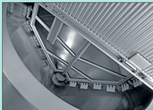
Innenansicht mit Dispergier- und Ankerrührwerk
